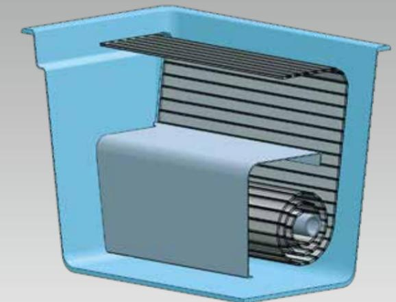
Il vano per la tapparella di questi modelli è posizionato direttamente dietro la vasca ed è dotato anche di un coperchio calpestabile in vetroresina dello stesso colore della piscina.
